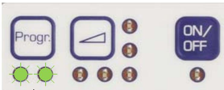
4000時間経過後、PROGボタン下のLEDランプが両方が3回点滅します。
